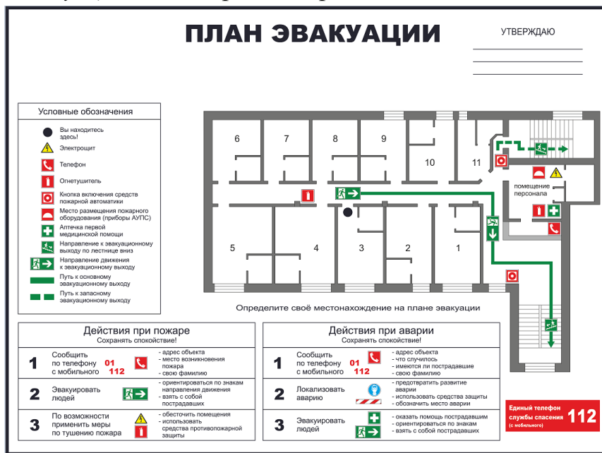
Рис. 13. Пример плана эвакуации при пожаре
